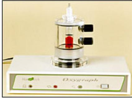
**Abbildung 10: Oxygraph-Messeinheit mit Messkammer und eingesetzter Clark-Typ-Elektrode (Hansatech-Instruments).**
