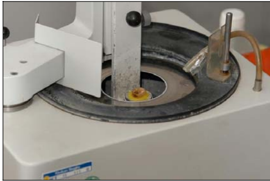
Abb. 4.13: Innenlochkreissäge mit eingespanntem Präparatehalter.
