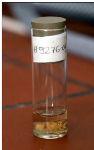
Abb. 4.11: Glasröhrchen mit noch flüssigem Methylmethakrylat und Probekörper.
