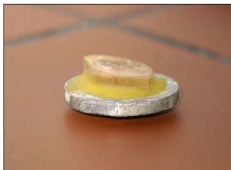
Abb. 4.12: Auf Präparatehalter fixierter Methylmethakrylatblock.
