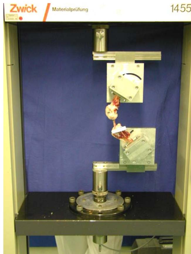
Der obere, femurtragende Zylinder war in Zugrichtung, also rechtwinklig zur oberen Traverse befestigt. Diese obere Traverse ist unbeweglich. Der untere, tibiaträgende Zylinder war parallel zur unteren Traverse angebracht. Beim Abwärtsbewegen der
