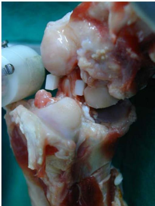
Diese slots dienten als Widerlager bei der Flächenbestimmung, die zu testenden Transplantate oder Bänder wurden mittels eindimensional beweglicher Stößel in die
