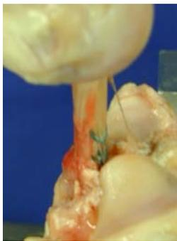
Versagen der tibialen Fixation im Bohrkanal („pull out“)
