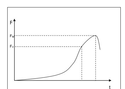
Abbildung 9: Verlaufskurve Versagenstest, Versagenslasten
