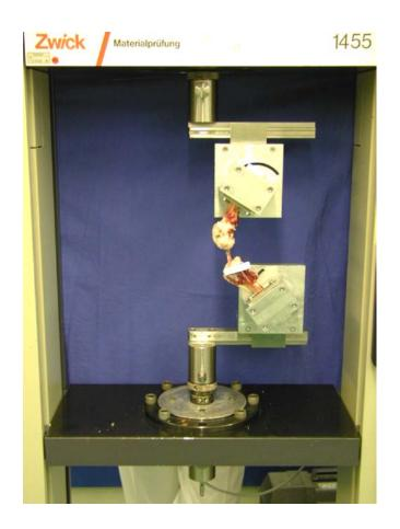
Der obere, femurtragende Zylinder war in Zugrichtung, also rechtwinklig zur oberen Traverse befestigt. Diese obere Traverse ist unbeweglich. Der untere, tibiatragende Zylinder war parallel zur unteren Traverse angebracht. Beim Abwärtsbewegen der
