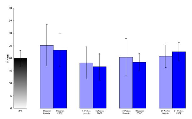
Abbildung 11: Ergebnisse Steifigkeit im Schubladentest
