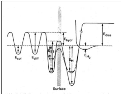
Abb. 5.6 Eindimensionales Potentialdiagramm der verschiedenen H-Zustände im Bereich der Pd-Oberfläche. Gezeigt sind von rechts nach links das Physisorptions- (E<sub>H2</sub>), Chemisorptions- (E<sub>H</sub>) Subsurfacepotential  $(E_{AS})$ sowie das Potential Volumenzustandes (E<sub>sol</sub>) und die Dissoziationsenergie (E<sub>diss</sub>) und Diffussionsbarriere unbedeckter  $(E_{diff})$ bei Oberfläche (durchgezogene Linie) und bedeckter Oberfläche (gestrichelte Linie)
