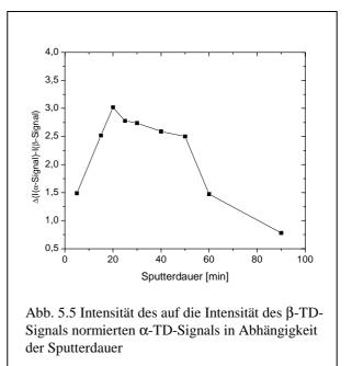
In Kapitel 6 zur Koadsorption von Wasserstoff und Kohlenmonoxid wird herausgestellt, daß schon für kleine CO-Bedeckungen die Besetzung des  $\alpha$ -Zustandes inhibiert ist. Sollte also CO aus dem Restgas während des zur Durchführung der Experimente notwendigen Abkühlens des Kristalls adsorbieren, nimmt dies Einfluß auf die Intensität des  $\alpha$ -TD-Signals und kann unter Umständen sogar dessen vollständige Unterdrückung bewirken.
