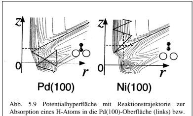
Abb. 5.9 Potentialhyperfläche mit Reaktionstrajektorie zur Absorption eines H-Atoms in die Pd(100)-Oberfläche (links) bzw. die Abstraktion eines H-Atoms von der Ni(100)-Oberfläche (rechts) [Oku99]
