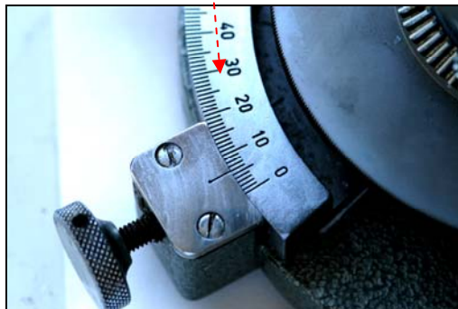
Abb. 14: Einstellung der gewünschten Dicke (6 \mu\text{m} )
