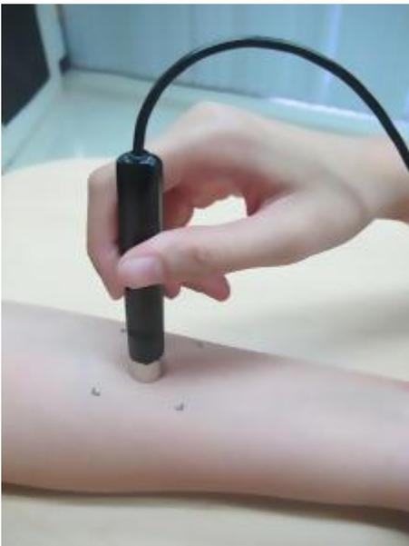
**Abbildung 6:** Messvorgang mit Mexametersonde
