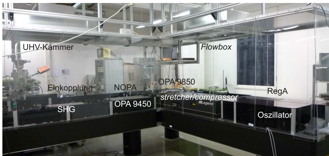
Abbildung A1: Foto des Lasersystems mit den Komponenten des CPA-Systems sowie den beiden OPAs und dem NOPA. Links der parametrischen Verstärker befindet sich der weitere Strahlengang mit Prismenkompressoren, Erzeugung der zweiten Harmonischen und Einkopplung in die UHV-Kammer.
