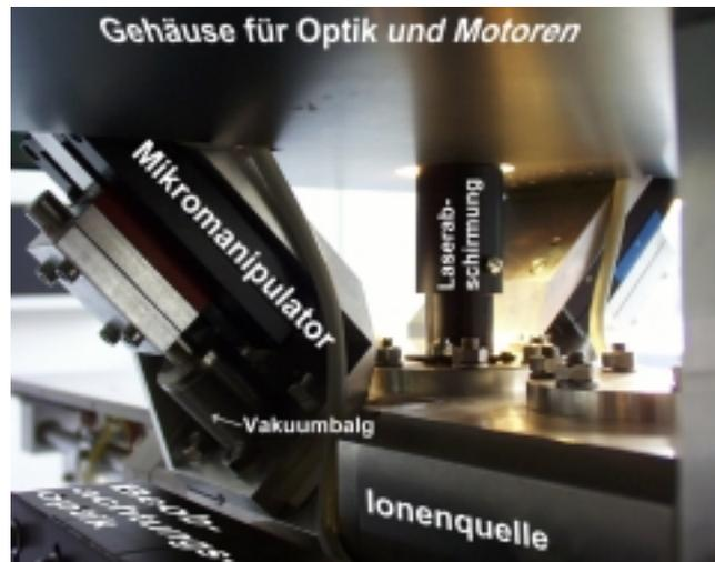
**Abbildung 2-8:** a) Vorderansicht der geöffneten Ionenquelle mit Gleichstrommotoren vor dem Umbau.
