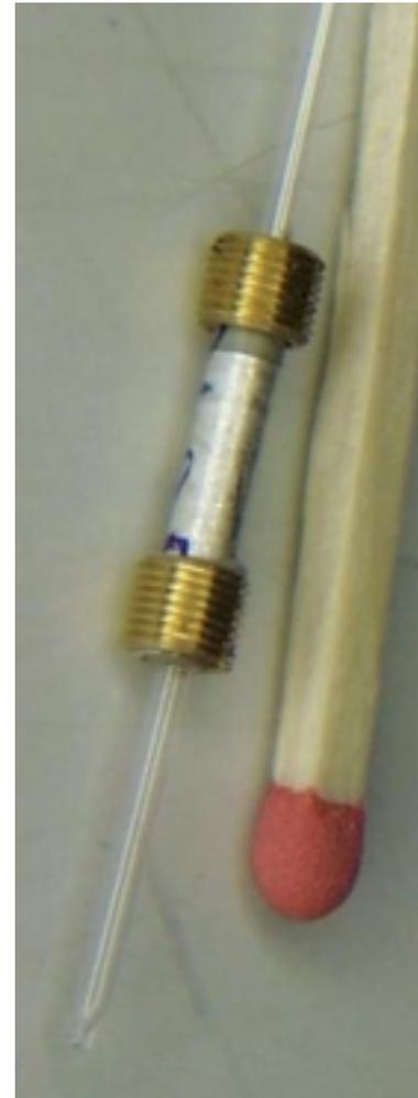
**Abbildung 2-2:** Schematischer Aufbau und Fotografie eines Piezojet-Mikrodispensers. (Das Streichholz dient dem Größenvergleich.)
