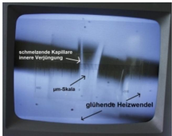
*Abbildung 2-1: Schmelzvorrichtung zur Herstellung verjüngter Borosilikatglaskapillaren für Piezojet-Mikrodispenser (links); Bildschirm zur Beobachtung des Schmelzprozesses (rechts).*
