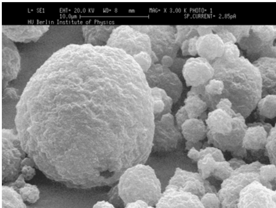
Abbildung 7-17: REM-Aufnahme von SPN-Compoundpartikeln mit einem Laktoseanteil von 70 % bei 3000facher Vergrößerung (ECNS 30).
