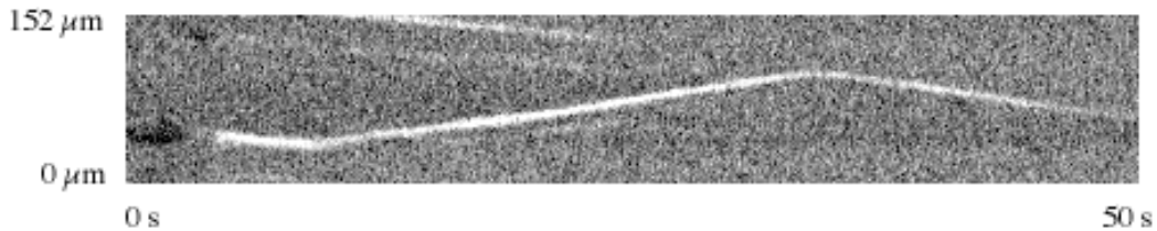
Abb. 4.51: x-t-Diagramm der Bewegung eines subsurface O-Gebietes in [1\bar{1}0] -Richtung. Während der Diffusion kommt es zweimal zu einer Richtungsumkehr des subsurface O-Bereiches. (Experimentelle Parameter: p_{\text{CO}} = 1,78 \times 10^{-4} mbar; p_{\text{O}_2} = 4 \times 10^{-4} mbar; T = 550 K.)
