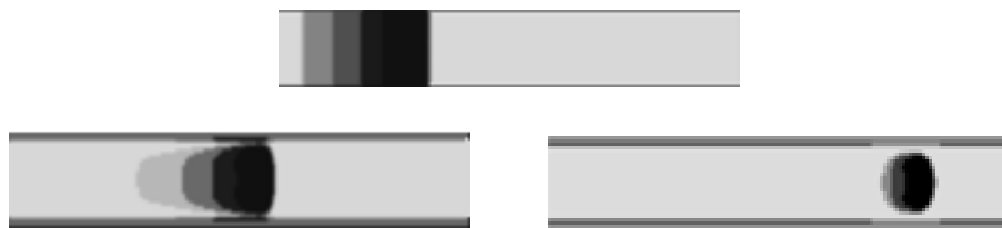
Abb. 4.18: Simulationen von O-Pulsen in einem Pt-Kanal. Die Rechnungen wurden mit Hilfe des 3-Variablen-Modells durchgeführt. Für alle drei Simulationen wurden in x-Richtung periodische Randbedingungen eingesetzt, um einen ausgedehnten Pt-Kanal zu simulieren. Um \text{TiO}_2/\text{Pt} -Strukturen zu simulieren, wurde für die obere Simulation in y-Richtung eine "no-flux"-Randbedingung ohne weitere Veränderung der Simulationskoeffizienten gewählt. In den beiden anderen Fällen wurde die CO-Adsorptionsrate gegenüber dem übrigen Kanal erhöht (links: 10%; rechts: 25%). So sollte der Fall simuliert werden, daß der Rand als CO-Quelle dient. Deutlich ist eine Einschnürung der Pulsrückseite zu sehen, die mit höherer CO-Adsorptionsrate zunimmt. (Größe des Simulationsbereiches: (oben) 300 \times 20 , (unten) 300 \times 28 .)
