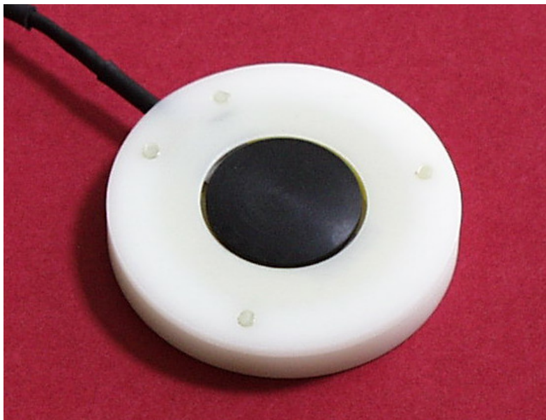
Abb.3.2 Photographie des Piezoschwingers von außen. Das runde schwarze Areal in der Mitte zeigt die abgerundete Auflagefläche. (Forschungswerksstätten Virchow Klinikum, Berlin)
