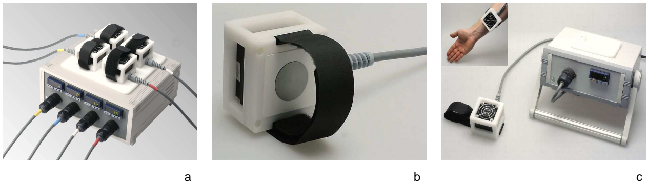
Abb. 2.3: a. TempTest ® 2.0; b. Provokationsareal mit thermoelektrischem Element; c. TempTest ® 2.1
