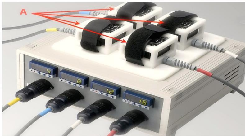
**Abb. 1.7:** TempTest® 2.0-Gerät, mit vier (A) thermoelektronischen Elementen zur Bestimmung der Schwellentemperatur bei 4 °C, 8 °C, 12 °C und 16 °C (AG Maurer, Charité)
