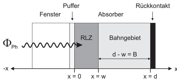
**Abbildung A.1:** Schematische Darstellung des Schichtaufbaus der Solarzelle. Auf der  $x$ -Achse ist der Ort senkrecht zu Schichtstruktur aufgetragen.
