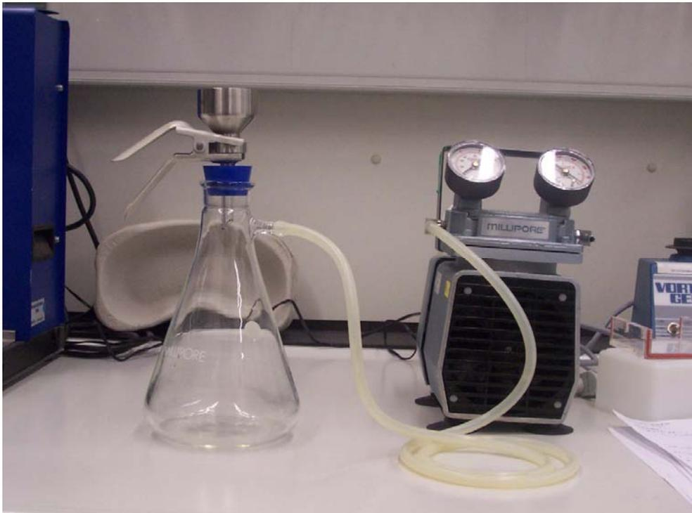
**Abbildung 2.5:** Vakuumpumpe zur Filtration und Trennung der Mikrosphärenpartikel von der Verdauungslösung.
