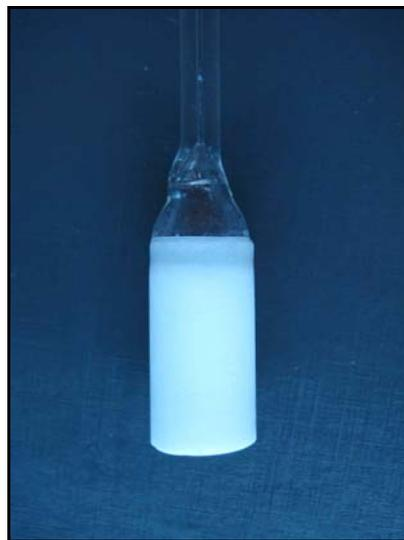
**Abbildung 57: Filterkerze aus porösem Glas (Typ VitraPor Kerze, Fa. Robu)**
