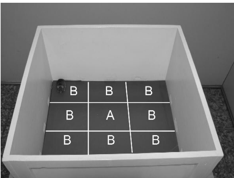
Abb. 5: Open field für die Aktivitätsmessung von Mäusen. Über dem Open field befindet sich eine Kamera, über die man außerhalb der Versuchskammer die Maus auf einem Bildschirm beobachten kann. Anhand von 2 senkrechten und 2 waagerechten Linien auf dem Bildschirm war das Open field in 9 gleichgroße Felder aufgeteilt. A markiert den inneren Bereich, B den äußeren Bereich des Open field.
