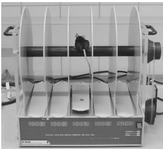
Abb. 7: Rotarod zum Testen des Koordinationsvermögens. Die Maus wird auf den sich drehenden Stab gesetzt. Wenn sie herunterfällt, löst sie die Kontaktplatte aus. Auf der Digitalanzeige kann man die Aufenthaltsdauer in s ablesen.
