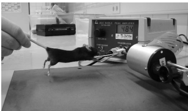
Abb. 9: Grip-strength Test zum Testen der neuromuskulären Stärke der Vordergliedmaßen. Die Maus greift beim Zurückziehen reflexartig einen Metallbügel. Wenn die nach hinten ziehende Kraft des Untersuchers die Muskelkraft der Maus übersteigt, lässt diese den Metallbügel los. Die Kraft kann man auf der Digitalanzeige ablesen.
