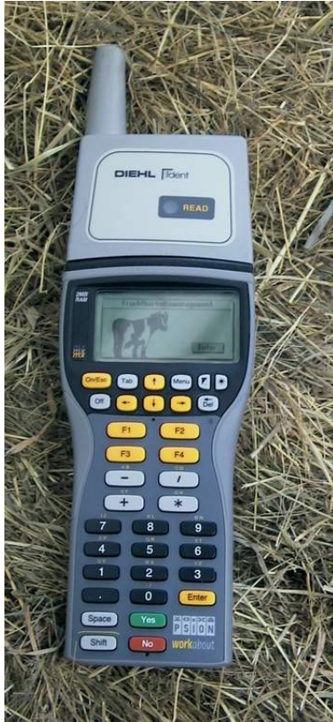
Abbildung 5: PSION ® Workabout mit Transponderlesekopf
