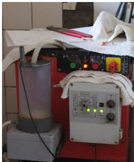
Abbildung 80: vorgefundener Kälbertränkeautomat älterer Bauart, links: Mischbehälter
