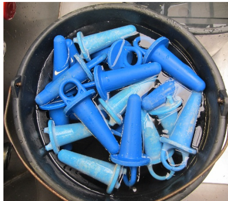
Abbildung 58: Blindstopfen in Desinfektionsbad, teils neu (dunkelblau), teils abgenutzt (hellblau) und mit rauer Oberfläche
