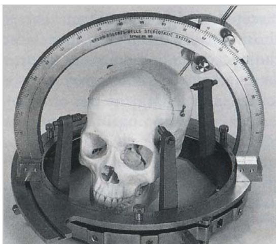
Abbildung 5.5: Stereotaxie-System zur Verwendung von CT-Daten nach Brown, Roberts und Wells.
