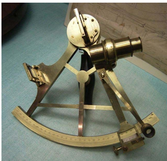
Abbildung 1.1: Spiegelsextant um 1810 zur Bestimmung des Breitengrades.
