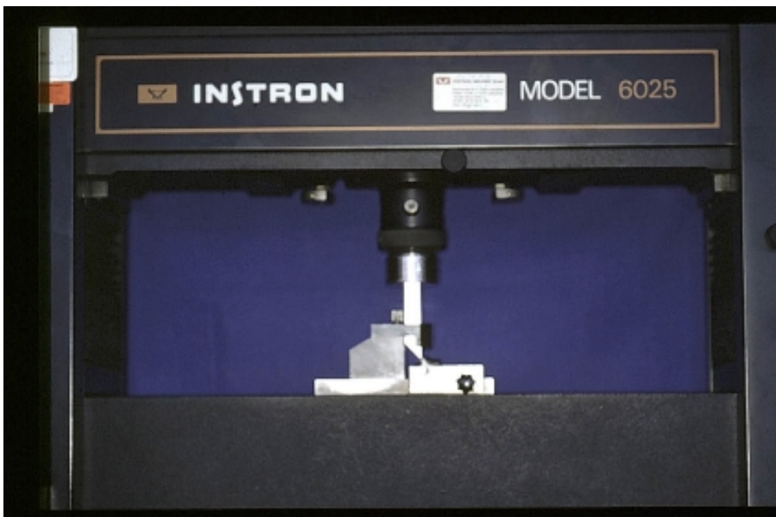
Abb. 24: Modifiziertes Abschergerät in der Instron-Prüfmaschine
