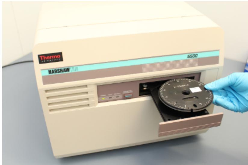
**Abbildung 10:** Auswerteeinheit Harshaw QS 5500<sup>®</sup>, Photomultiplier [61]
