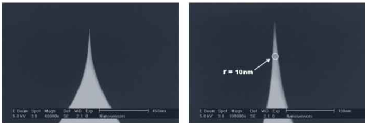
Abbildung 8: Raster-Elektronen-Mikroskopische Aufnahme zweier ultrascharfer Siliziumsonden. Die Aufnahmen stammen vom Hersteller. Der Spitzenradius beträgt zwischen r_{\text{tip}} = 2 bis 5 \text{ nm} . Der Öffnungswinkel der Sonden beträgt bis zu einer Distanz von 200 \text{ nm} (zur Spitze) unter \alpha = 20^\circ .
