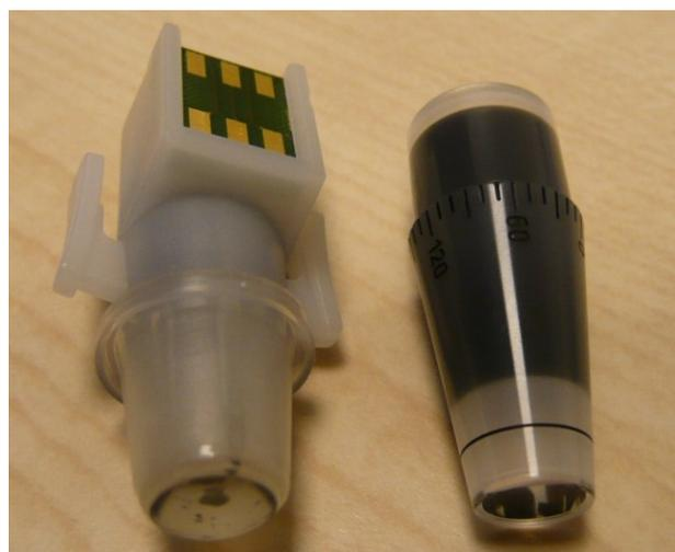
**Abbildung 16:** Messköpfchen: Links PASCAL<sup>®</sup>-Tonometer mit Hygiene-Kappe, rechts Goldmann-Tonometer (Eigenes Foto, Freund 2008)
