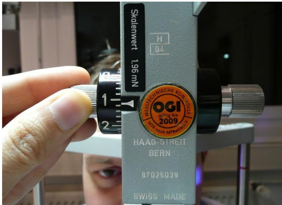
**Abbildung 15:** Einstellung der Kalibrierschraube des Goldmann-Tonometers (Eigenes Foto, Freund 2008)
