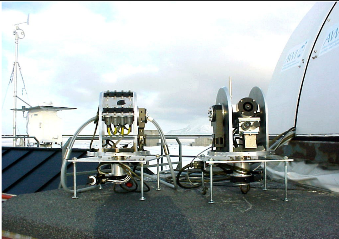
Abbildung 5.4: Einkoppeloptiken FUBISS-Polar (links) und FUBISS-ASA1 (rechts)
