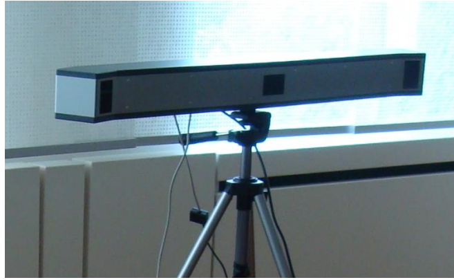
Abb 14: Array mit 3 Infrarotkameras
