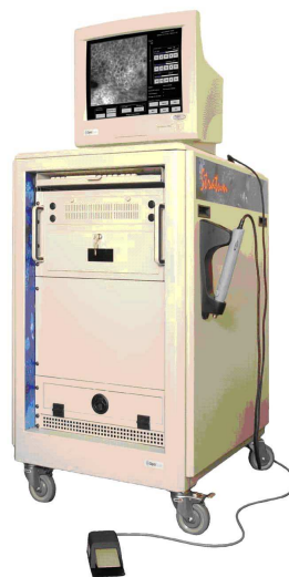
Abbildung 20: konfokales Laser-Scan-Mikroskops „Stratum“ (OptiScan Ltd., Melbourne, Australien)
