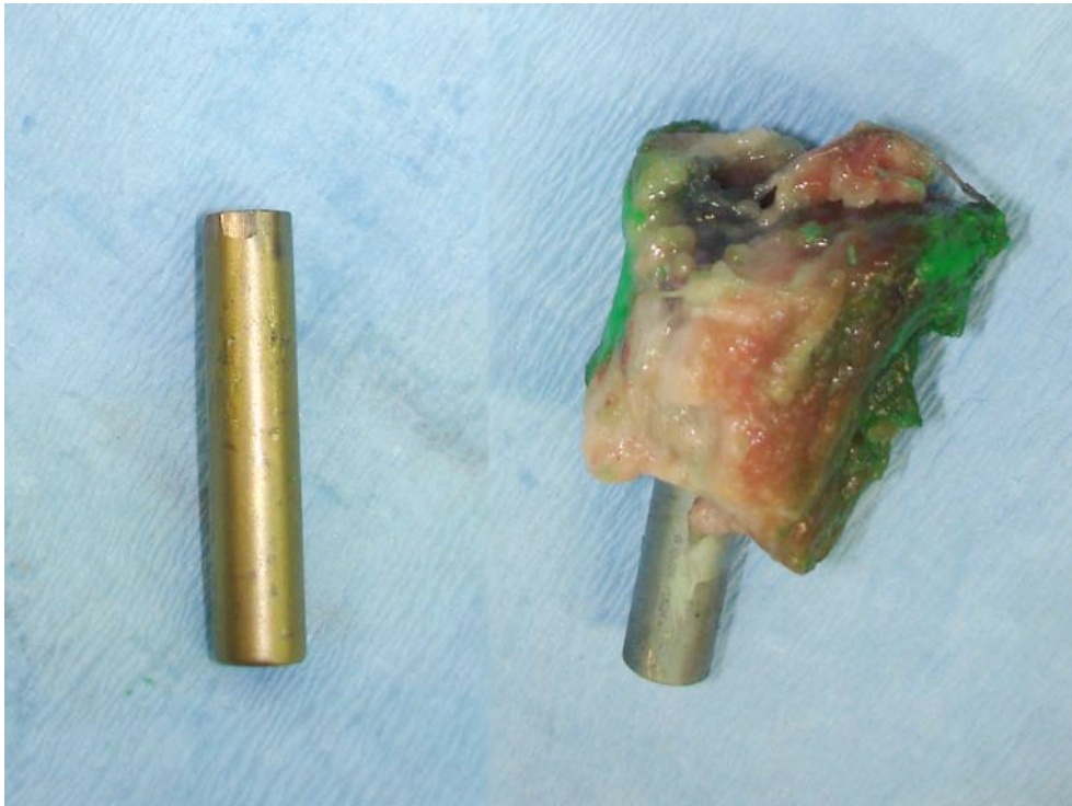
Abb. 27: einseitig defektes Implantat bei einem Präparat der Gruppe 2A
