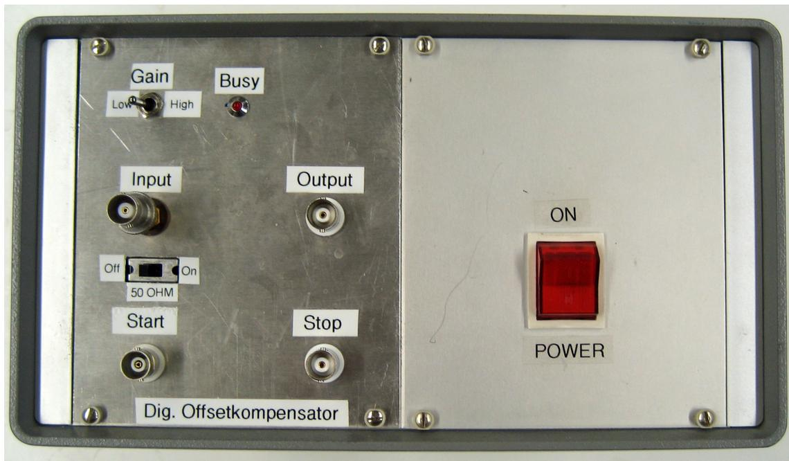
Abbildung 11.2: Foto des digitalen Gleichspannungskompensators
