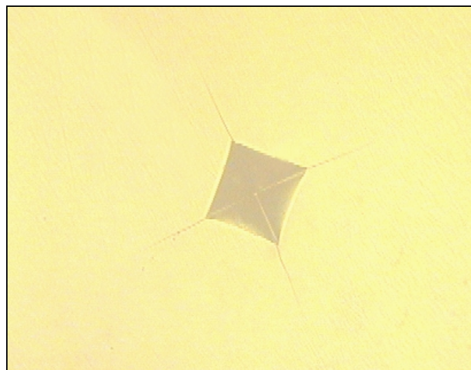
Abb. 5.5: Lichtmikroskopische Aufnahme eines Vickers-Härteeindruckes auf der Keramik Cercon base
