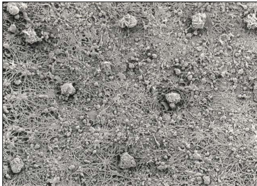
Abb. 3.8: Innenfläche einer PTFE-Gefäßprothese, welche mit Hirudin und Iloprost angereichertem Polylaktid beschichtet wurde (1000-fache Vergrößerung im Rasterelektronenmikroskop).
