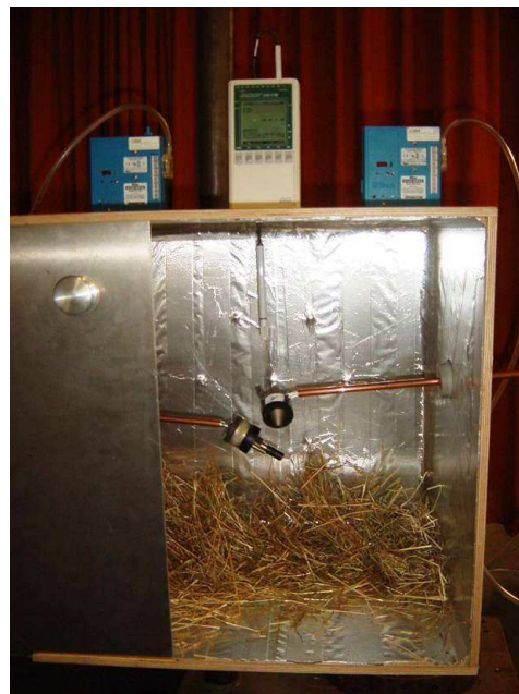
Abbildung 3.8: Staubfreisetzungswürfel mit PGP-GSP und –FSP Sammelköpfen, sowie dem Ahlborn Klimamessgerät
