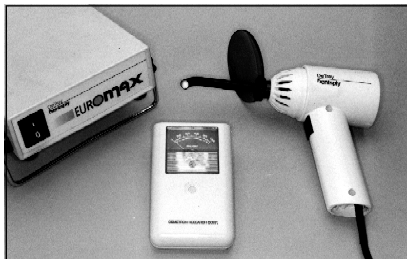
Abbildung 21: In der Studie verwendetes Polymerisationsgerät und Radiometer
