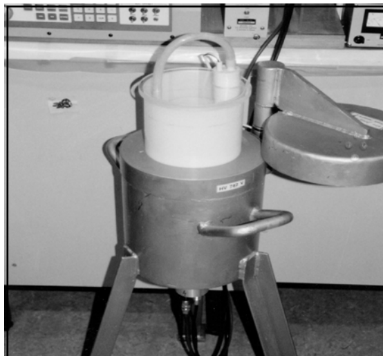
Abbildung 18: NaJ-Detektor in einer Bleiabschirmung und aufgesetztem Marinelli-Behälter
