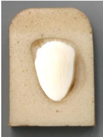
Abb. 5.3: hochglanzpolierter Schmelzprüfkörper eingebettet in einer schnellhärtenden Zweikomponenten-Polyurethangießmasse
