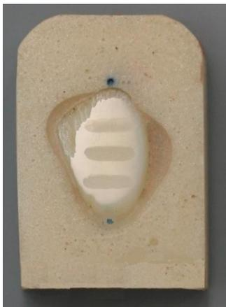
Abb. 5.14: Schmelzprüfkörper nach Bestrahlung mittels  $\text{NaHCO}_3$
