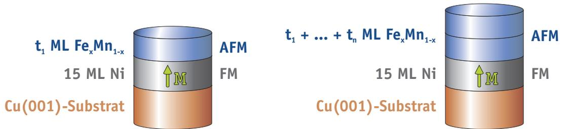
**Abbildung 4.12.:** Schematische Darstellung der Proben aus Serie (C). Die AFM  $Fe_xMn_{1-x}$ -Lagen wurden Schritt für Schritt aufgewachsen und vermessen. Die Ni-Schicht wurde in einer Hälfte der Proben für 20 min bei 450 K getempert.
