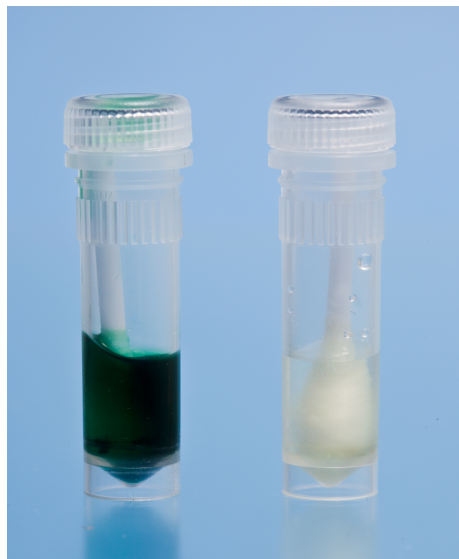
Abb. 8: HemoCheck-S-Test: Färbung nach Aktivierung; links: starke Reaktion; rechts: keine Reaktion
