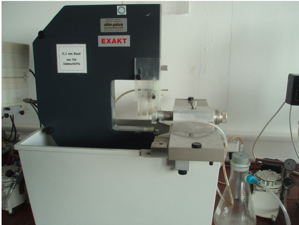
Abb. 7 Exakt Säge für Dünnschnitte
