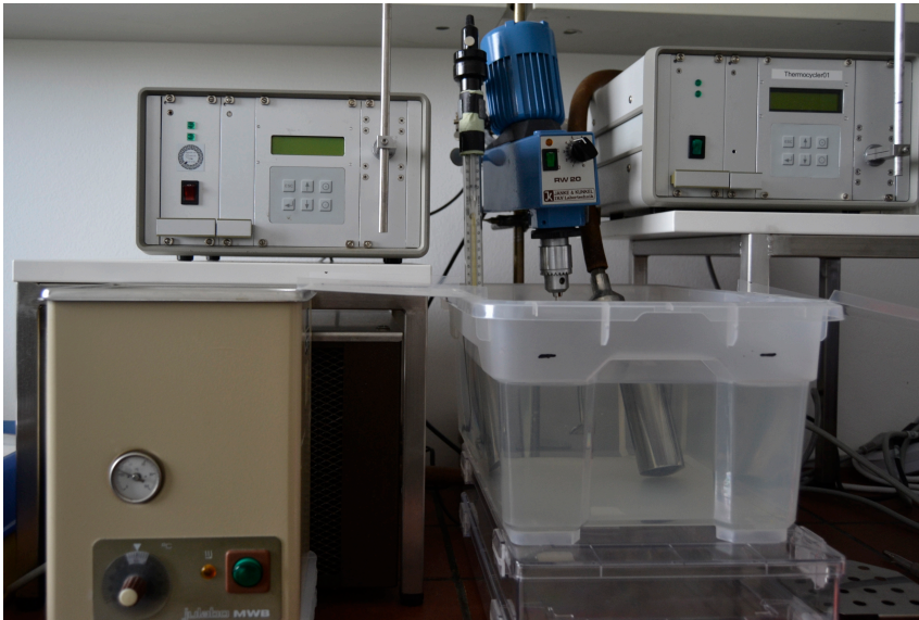
Abb. 6 Gerät für die thermozyklische Wechsellast
