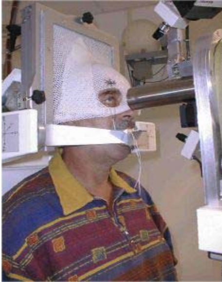
Abbildung 28-1: Patient mit Gesichtsmaske, Beißblock und Lidhaltern in Bestrahlungsposition. Ebenfalls sichtbar ist die Kamera, welche eine kontinuierliche Überwachung der Position des Patientenauges durch das Kontrollteam ermöglicht. ( Quelle: Internetseite des Hahn-Meitner-Instituts, www.hmi.de )
