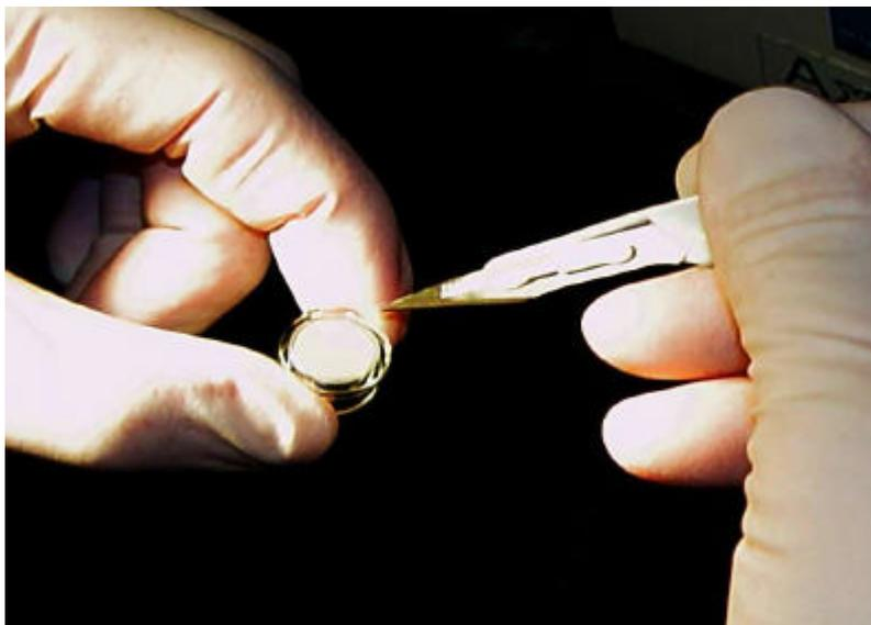
**Abb. 9: Präparieren der Filtermembran**
