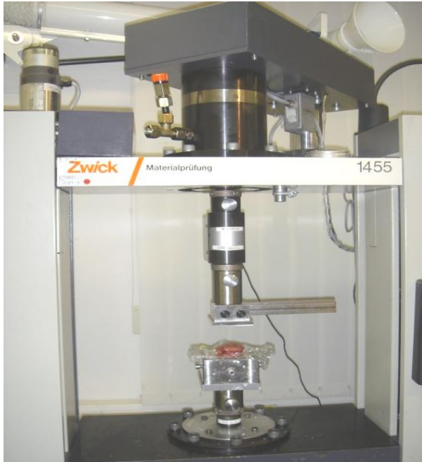
Abbildung 12 Materialprüfmaschine Zwick 1455 im Biomechaniklabor mit unterer Traverse, die den eingebetteten Wirbelkörper gegen die obere Traverse (welche den Druckaufnehmer mit der Messvorrichtung enthält) fährt.
