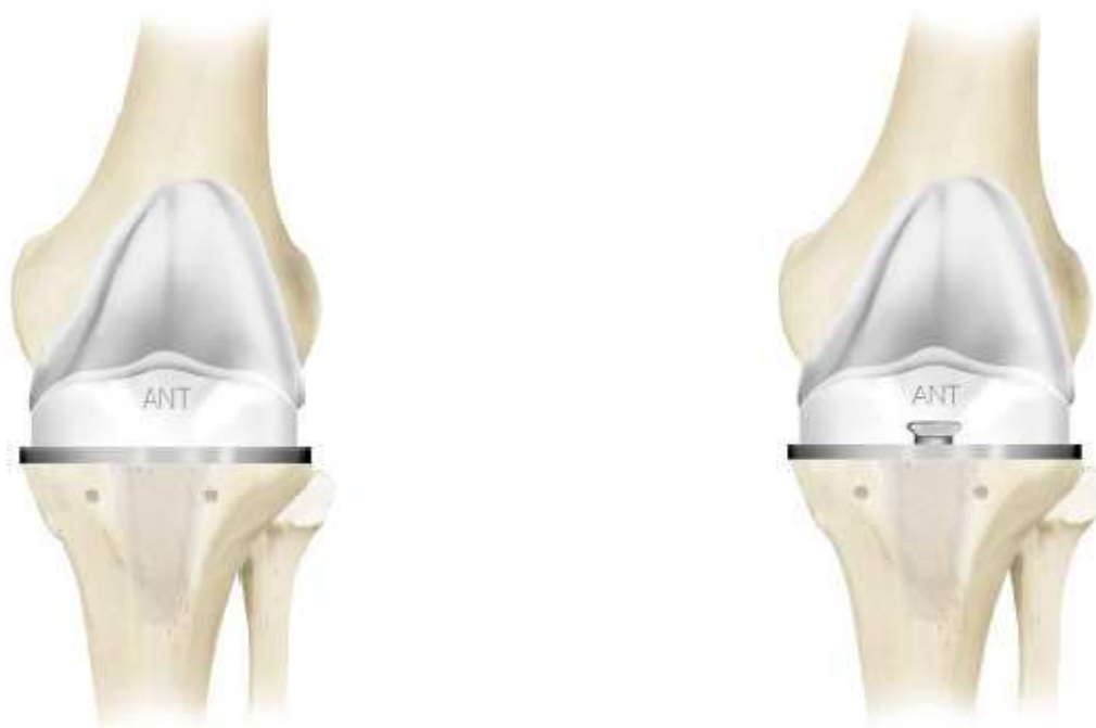
Abbildung 3: Schematische Darstellung LCS Prothese mit RP- Gleitlager links und APG- Lager rechts [17]
