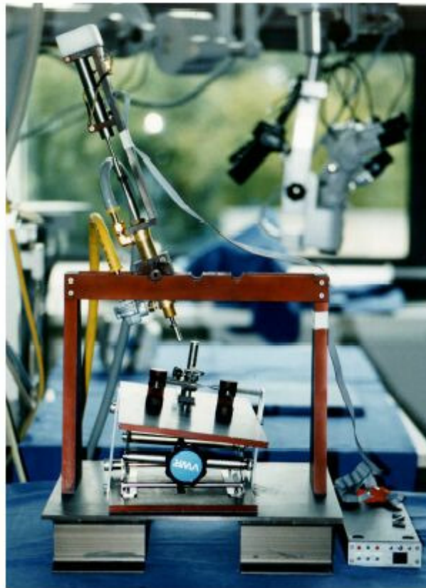
Abb. 4: Ansicht der CCII-Kontusionseinheit mit Kontusionsschlitten, Schlagbolzen und Kontusionstisch zur Lagerung der Tiere
