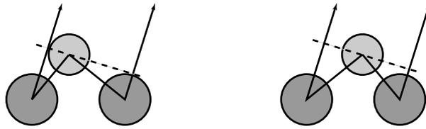
Abbildung 4.5: Illustration zur Entstehung unterschiedlicher Gangunterschiede am Detektor für gleichwertige Domänen außerhalb einer Symmetrieposition.
