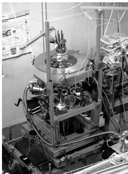
Abb. 2.1: Das neue UHV-Diffraktometer im Einsatz am UE46-PGM1 Strahlrohr am Synchrotron BESSYII in Berlin.
