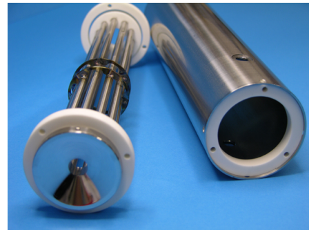
Abbildung 2.8: Durch viele Stöße mit dem Puffergas (Helium) im Dekapol werden die Ionen thermalisiert und verlieren interne Energie. Die Ionenwolke wird sowohl im Orts- als auch im Impulsraum komprimiert. Diese Phasenraumkompression ist für die weitere Ionenführung durch die Apparatur vorteilhaft [71, 72], da durch die schmalere Verteilung der kinetischen Energie enger definierte Anfangsbedingungen für das Fangen der Teilchen in der Ionenfalle gegeben sind. Die Abbildung stammt aus Referenz [73].
