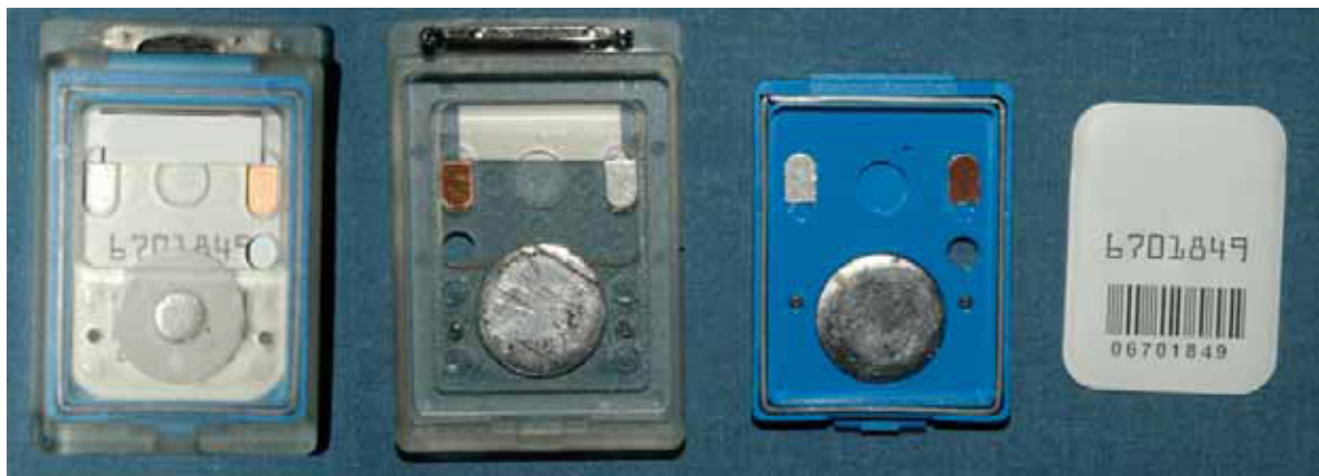
Abbildung 2: Plakettenfilmdosimeter Typ BE-Gs-GD 01: Von links nach rechts: Einsatzfähiger Dosimeter, Vorderer Teil, hinterer Teil, Film
