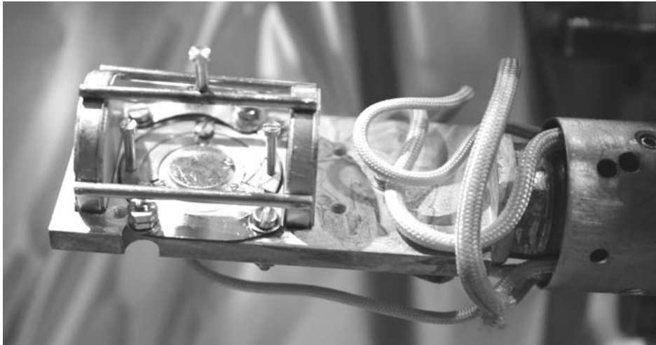
Foto 4.1.2_3: Foto des magnetischen Systems auf dem Manipulator.
