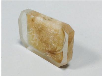
**Abb. 13 Geschliffener PMMA-Block für die Anfertigung der Dünnschnitte**
